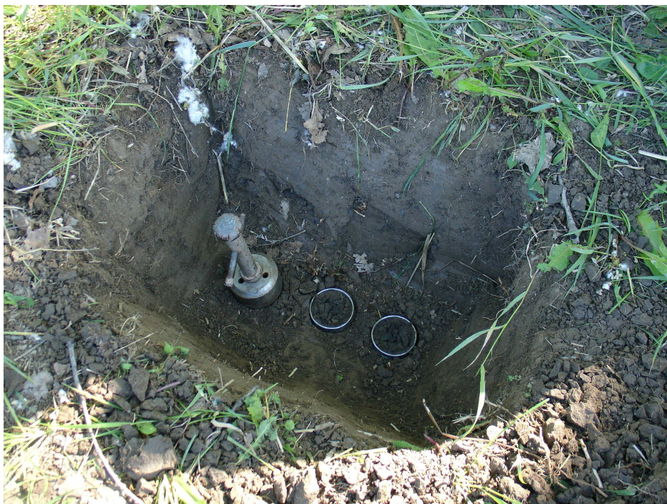
Obr. 2 odběr půdních vzorků pomocí Kopeckého válečku
