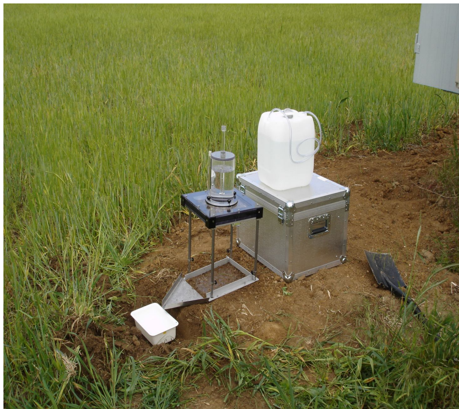
Obr. 1.2: Ukážka použitia dažďového simulátora
