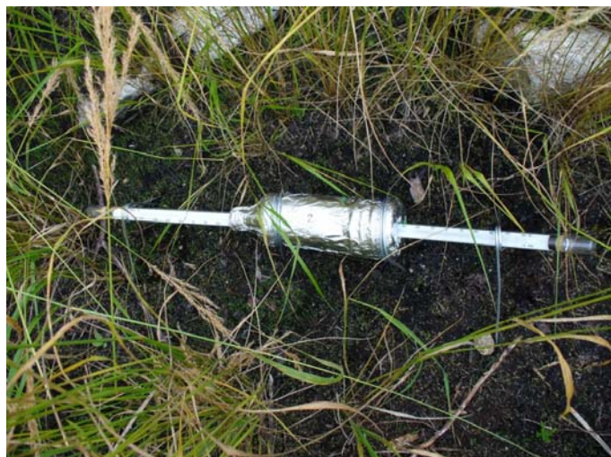
Obr. 2 Umiestenie sústavy extrémnych teplomerov na výskumnej ploche
