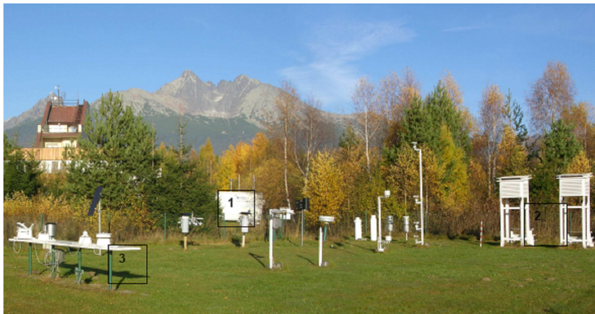
Obr. 1. Meracie prístroje a zariadenia na meteorologickom observatóriu GFÚ SAV Stará Lesná: 1 - automatická monitorovacia stanica SHMÚ na prízemný ozón a znečistenie ovzdušia; 2 - teplota a vlhkosť vzduchu; 3 - radiačné prvky.
