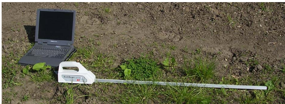
Obr. 12 – zařízení SunScan SST1 k ambulantnímu měření intenzity FAR
