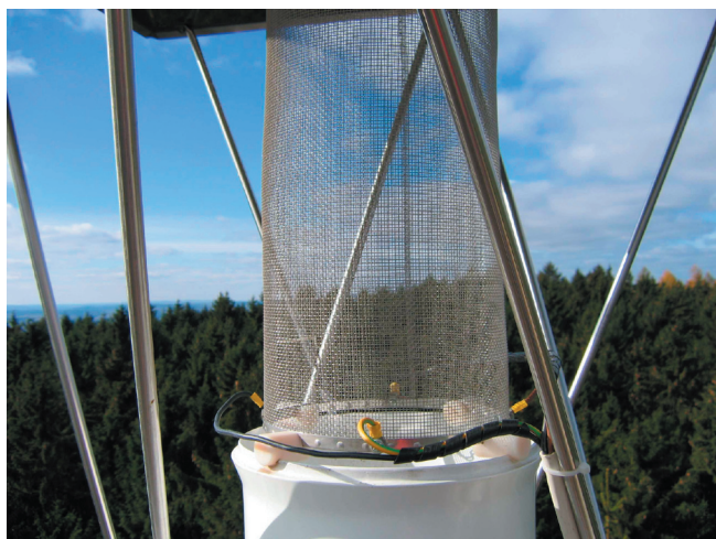
Obrázek 1 Detailní pohled na konstrukci srážkoměru.
